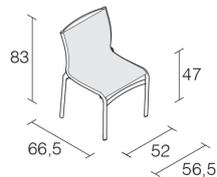
Chaise empilable avec structure composée de profil d'aluminium extrudé et d'éléments en fonte d'aluminium. Assise et dossier en tissu polyester maillé ignifuge, en en simili cuir Serge Ferrari®, en tissu Camira®, Reviva® ou Kvadrat® ou en cuir Pelle Frau®.
